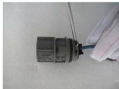
Abbildung 4.16 Anschluss der Drähte an die Klemme
